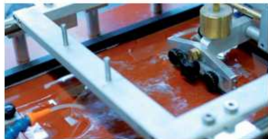
Abriebfestigkeit Bei der Bühler-Testmethode wird ein handelsüblicher Gummiabzieher, der mit 450 g belastet wird, maschinell über eine beschichtete Glasscheibe geschoben und gezogen. Ein Wischzyklus besteht aus einer Schieb- und einer Ziehbewegung.
